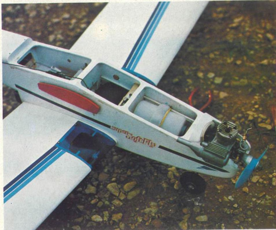
Sur le terrain, on apprécie particulièrement l'accessibilité à la radio et le contrôle visuel du réservoir.
