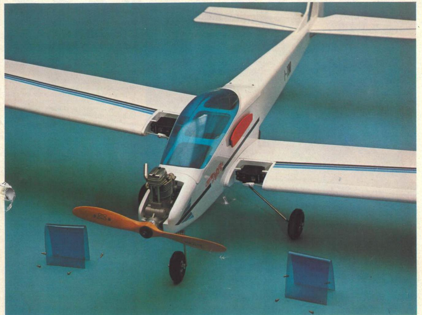
On voit ici en gros plan la principale originalité : les ailes peuvent être positionnées en position basse ou médiane au choix. Pour rendre la transformation aisée sur le terrain, Scorpio a prévu l'installation d'un servo par aile dans son bord d'attaque.
